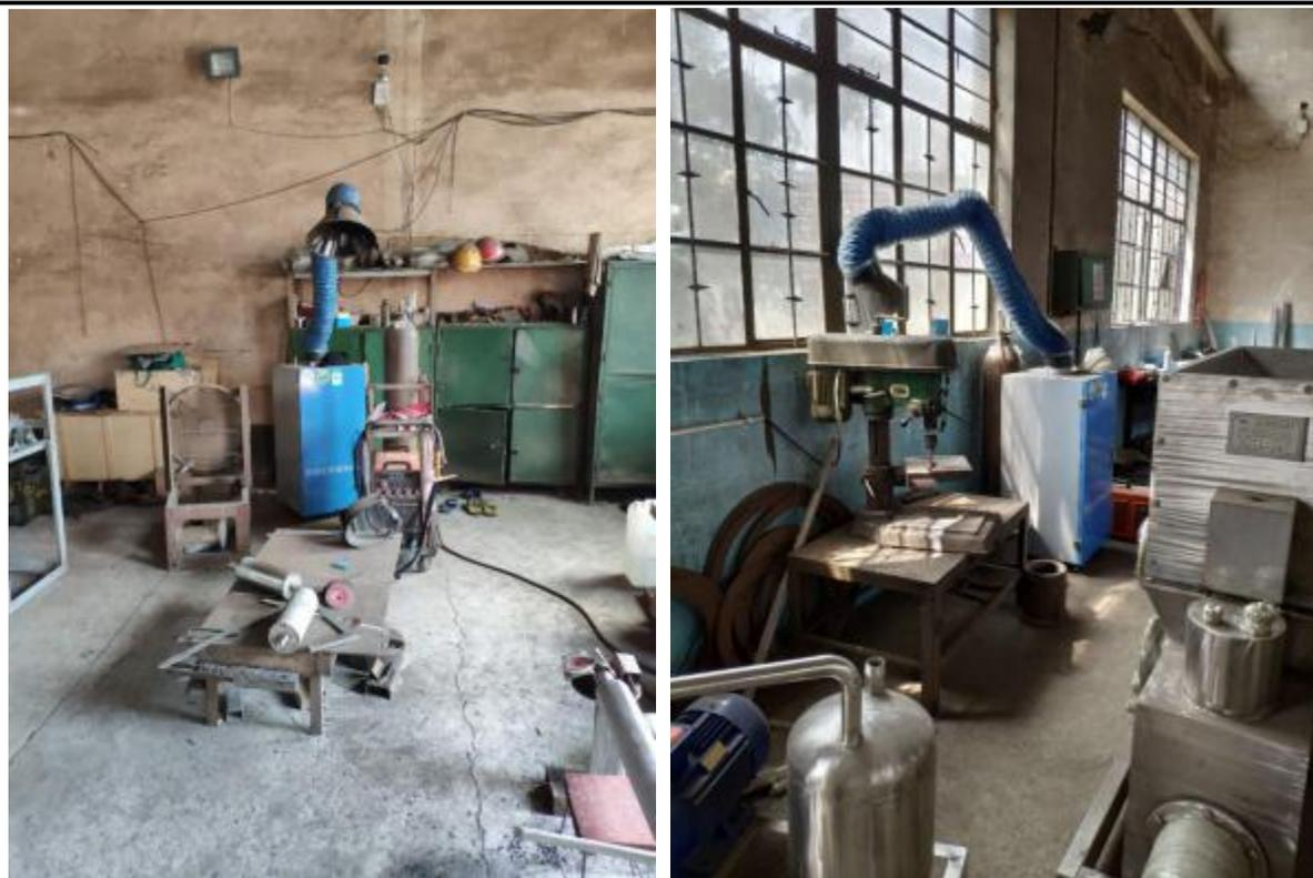
图 3-1 移动式焊烟净化器
