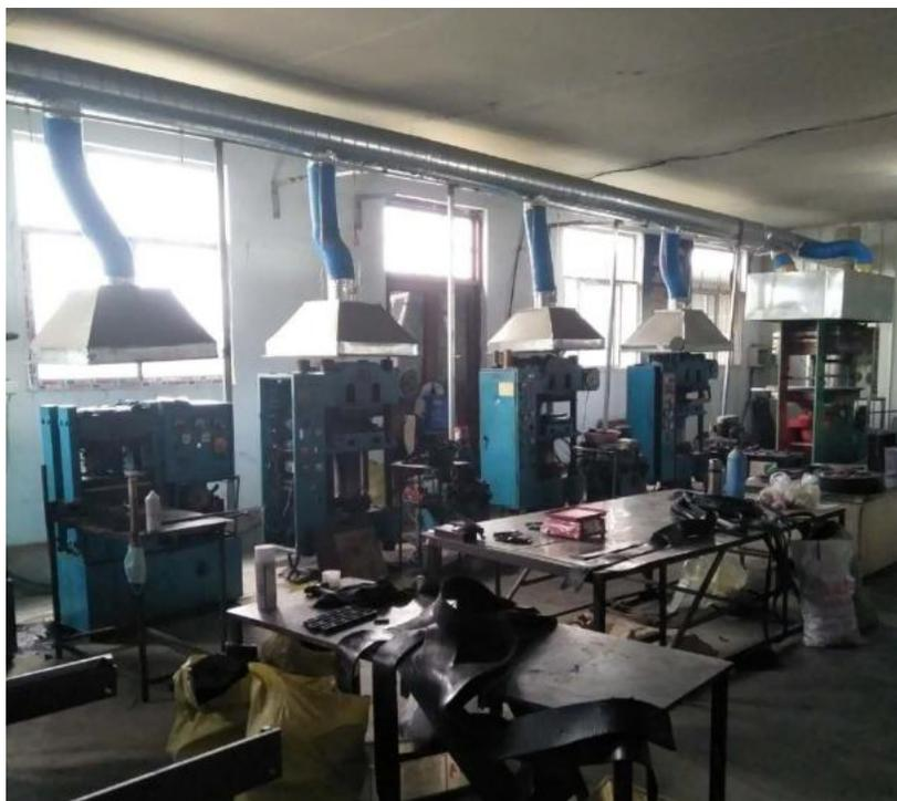
**图 4-1 成型工序集气**
